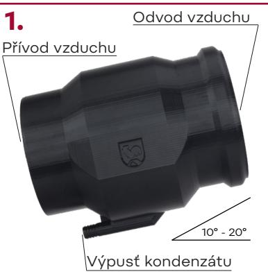
V místě potrubního vedení, kde je požadován odvaděč kondenzátu vložíme tento mezíkus se sklonem 10° - 20° od horizontální roviny. Výpusť kondenzátu směrem dolů.
