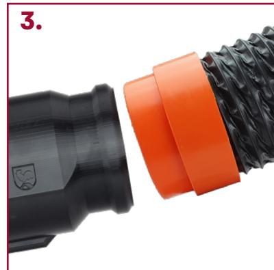
Do odvaděče lze shora napojit koncovka flexibilní hadice odvětracího kompletu DN 160 a nebo pokračující potrubní vedení KG a HT. V případě napojení přímo na flexibilní hadici je nutné odříznout koncovku hadice na správný průměr.
